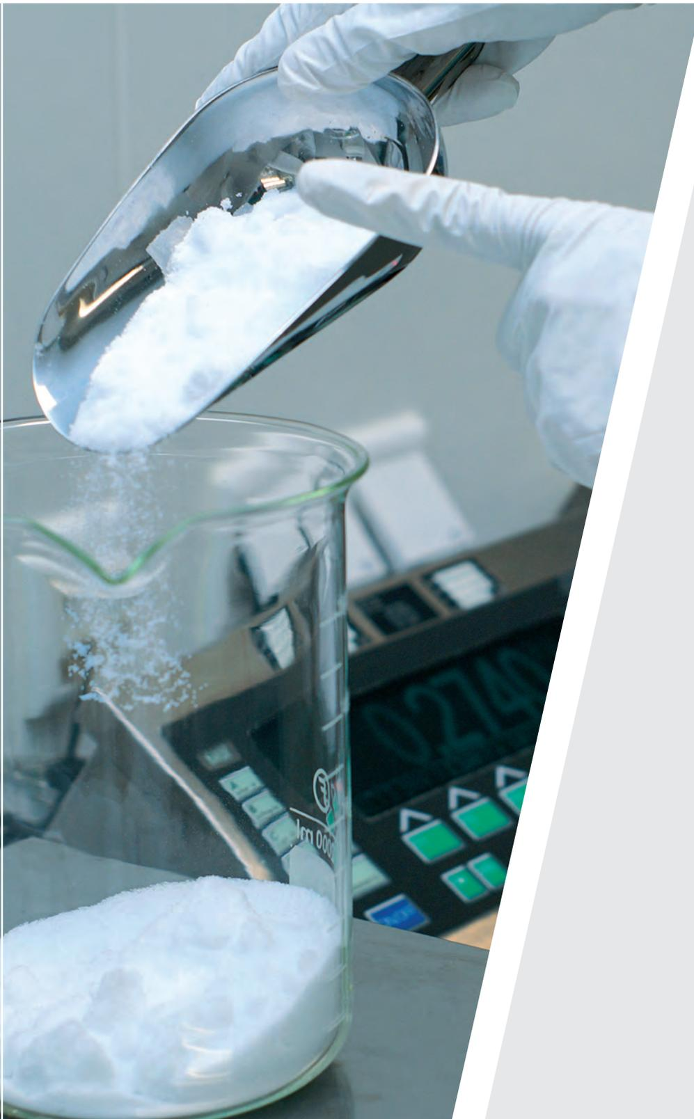
Auf computergesteuerten und -kontrollierten Wiegeplätzen führen wir das Einwiegen der Grundsubstanzen durch. In Edelstahlbehältern verschiedenster Volumina (von 20 bis 1.000 Litern) bereiten wir sowohl Lösungen als auch Suspensionen und Emulsionen zur Sterilfiltration und Abfüllung vor.
